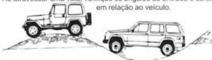
O comprimento do veículo interfere nos ângulos de entrada e saída das valas.
