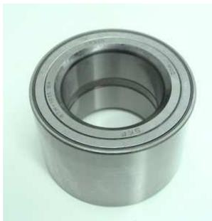
A manga SHD utiliza um rolamento blindado, originalmente aplicado no eixo traseiro do Iveco Daily. Ele robusto e lubrificado, dispensando qualquer lubrificação complementar como graxa por exemplo, além de eliminar por completo o problema de danos sofridos por rolamentos cônicos devido a folgas nos cubos.
