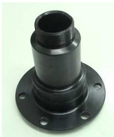
Mangas em aço “FORJADO” com 55mm de diâmetro. Fazendo um comparativo, as originais possuem diâmetro de 41mm e as mangas HD Ensimec tem em sua parte mais reforçada o diâmetro de 45mm, ou seja, muito mais resistência devido ao ganho de dimensões.
