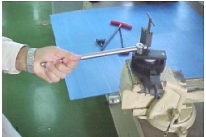
5º) Após o tensionamento da engrenagem, os dentes da engrenagem devem ser alinhados através do alinhador da base da ferramenta.
