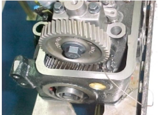
Os cabeçotes dos motores Sprint das aplicações S-10 e BLAZER, ou seja, com engrenagem pré-tensionada original de fábrica, possuem um alojamento interno da engrenagem mais largo, não sendo possível portanto montar a engrenagem pré-tensionada em cabeçotes antigos.
