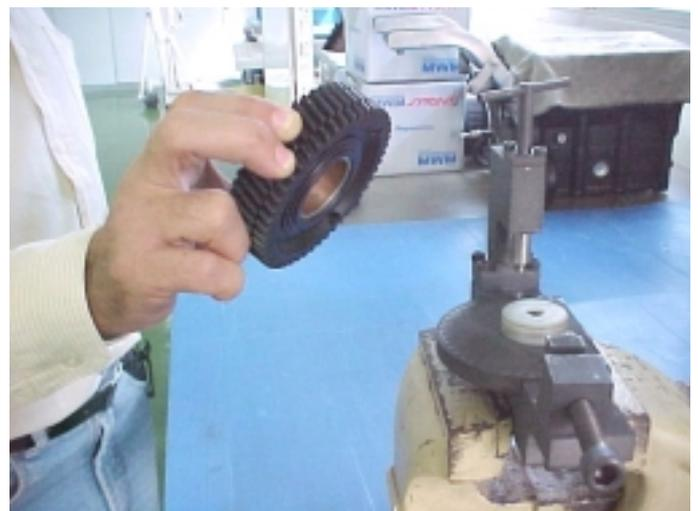
3º) O pino da chave de tensionamento da engrenagem deve se encaixar no furo da engrenagem conforme indicado na ilustração.
