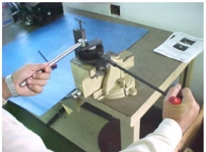
6º) Após o alinhamento dos dentes da engrenagem, deverá ser instalado o grampo de travamento MWM nº 9.407.0.690.050.6 que irá mantê-la tensionada para a montagem no motor. Para se colocar o dispositivo, deve-se encaixar os dois pinos nos furos da engrenagem e apertar o parafuso central a tal ponto de manter a engrenagem segura para ser retirada do suporte do dispositivo.
