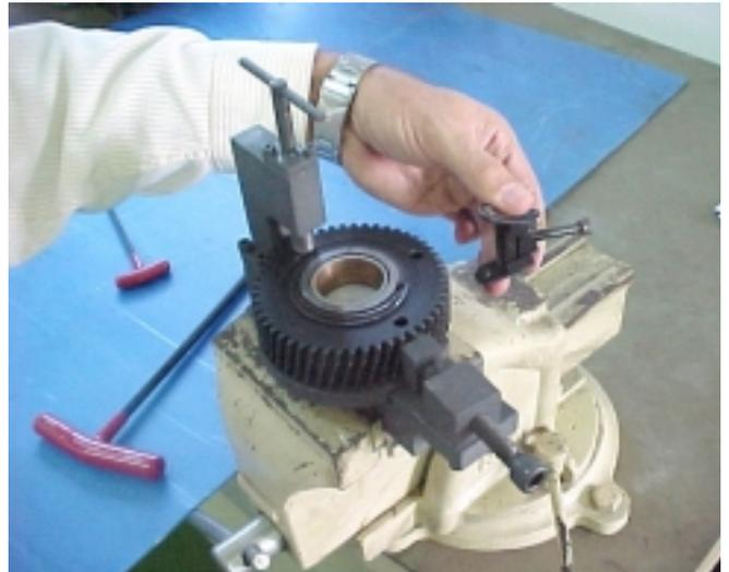
7º) Após a instalação da trava, remover a engrenagem do dispositivo para a instalação no cabeçote.
