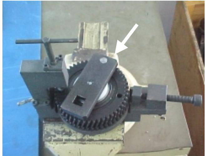
4º) Com um cabo de força pequeno, gire a chave de tensionamento até o furo do lado superior da engrenagem coincidir com o pino de travamento da base da ferramenta. Neste momento a engrenagem estará com o tensionamento desejado.
