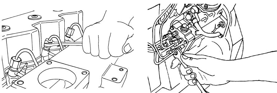
**TUBERÍA DE COMBUSTÍBLE****verificar y reapretar**
