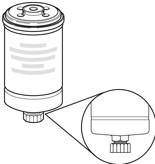
Remover o bujão de drenagem de água, localizado na parte inferior do filtro de combustível.
