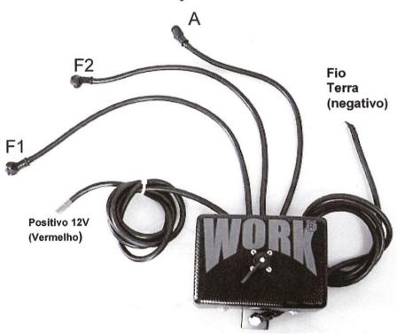
Conecte os cabos que saem da caixa de solenóides nos contatos do motor conforme é indicado na figura acima. No motor existe a indicação onde cada cabo deve ser conectado (F1, F2 e A).
