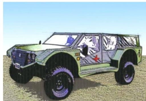
**Opções 1 e 2. Na 1, à esquerda, permite transportar quatro feridos em macas, duas no teto e duas nas laterais e ainda quatro soldados sentados. Na 2, à direita, com capota fechada, permite levar três feridos em macas, protegidos das intempéries. (Fotos: Ejército Argentino)**
