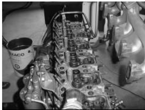
Figura 04 – Desmontagem do motor Fonte: CENBIO, 2003
