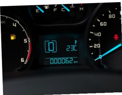
A tela central de LCD localizada no quadro de instrumentos exibe os dados do computador de bordo, como autonomia do combustível, consumo médio, consumo instantâneo, temperatura externa do ar, dois hodômetros parciais para medição de trajetos e velocidade média.
