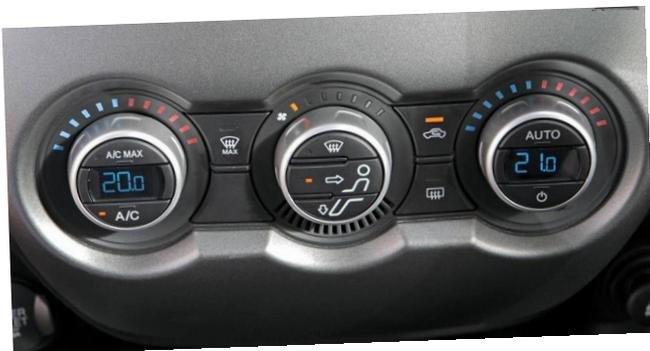
lado da cabine. Ele pode ser usado no modo mono ou dual. No primeiro, a temperatura escolhida pelo motorista é a mesma em toda a cabine. No modo dual, é possível ajustar a temperatura de cada lado de forma independente. O sistema também realiza automaticamente os ajustes necessários para manter
