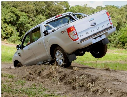
E o desempenho fora de estrada é favorecido pela maior rigidez torsional da carroceria, o dobro da geração anterior. Além disso, a Nova Ranger absorve com facilidade quaisquer ondulações do piso, com a distância entre-eixos ampliada para 3.220 mm, a maior da categoria
