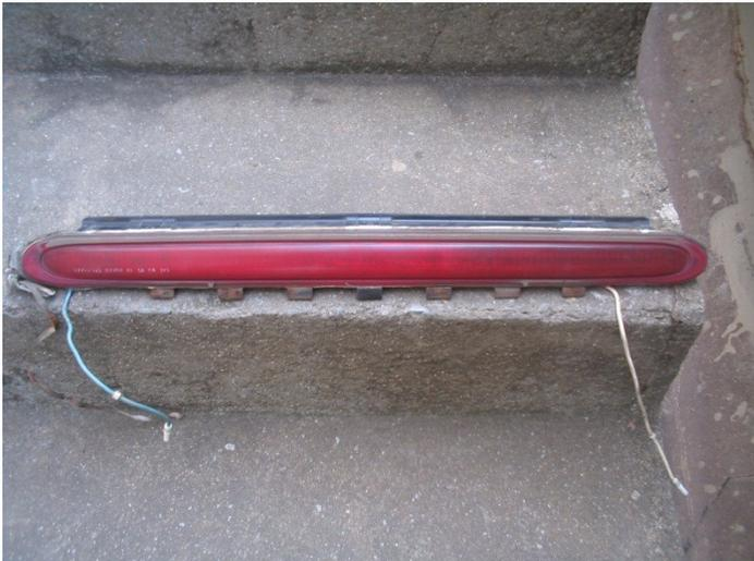
Uma boa lavada para retirar a poeira corte os fios secar bem e colocar no forno aprox. 200graus por 05 a 10 minutos somente para soltar a lente muito cuidada nesta parte para não deformar a lente (isso mesmo forno de cozinha risos). Após soltar a lente retire a lâmpada e uma boa limpada e interna
