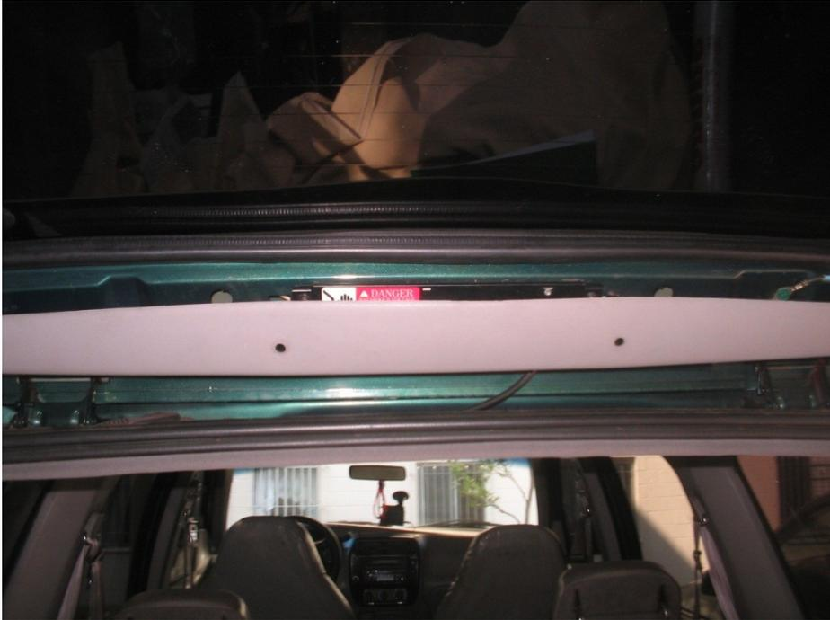
Retirar o reator cuidado alta tensão (risos) não deixe ninguém dentro do carro, pois se pisar no freio risco de choque.
