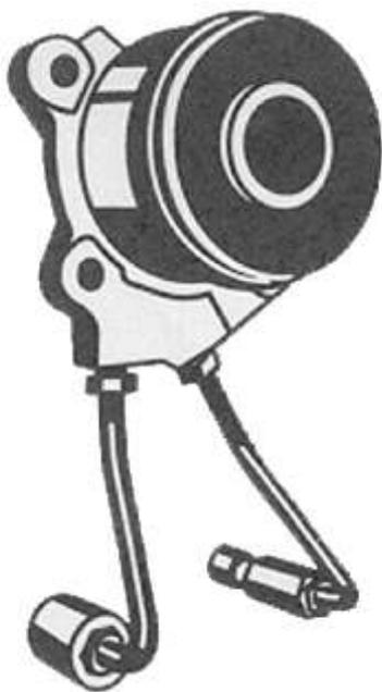
Toda embreagem que é acionada por meio de atuador hidráulico concêntrico. Deve ser verificado a necessidade de ser substituído.
