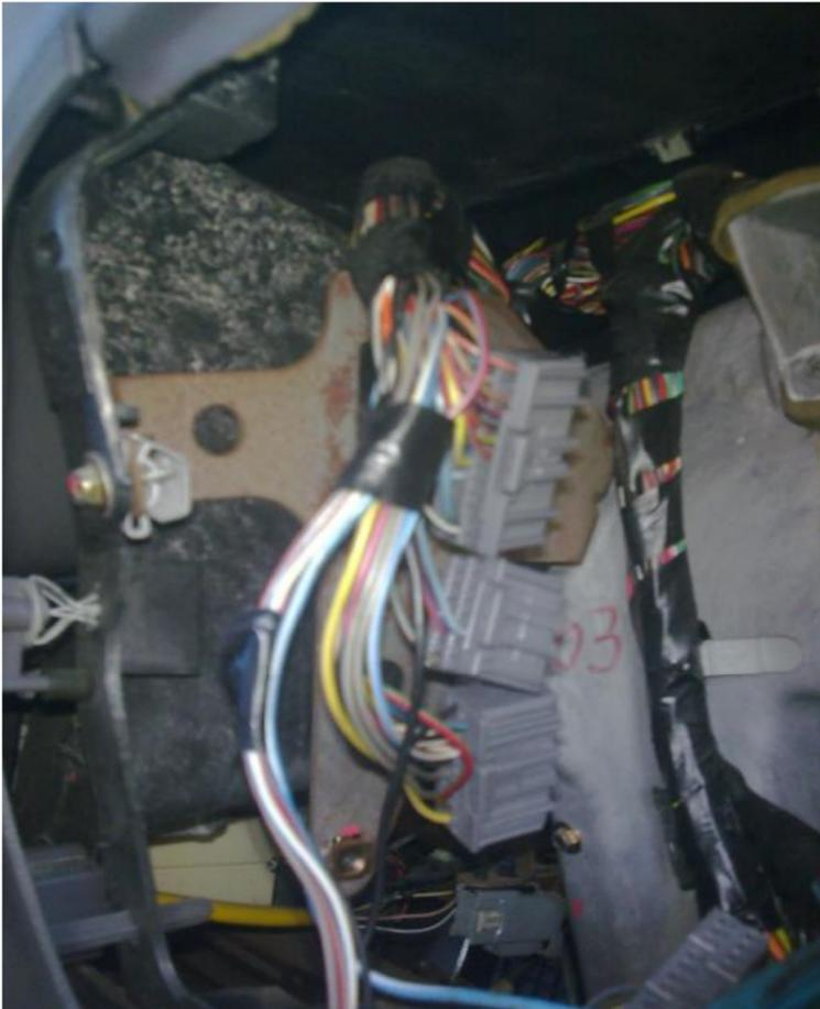
LADO ESQUERDO DO PAINEL. 03 DOS 04 CONECTORES QUE VÃO PARA O MÓDULO
