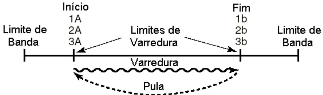
A varredura programada P1 varre entre as frequências 1A e 1b, P2 varre entre 2A e 2b, e P3 varre entre 3A e 3B.
