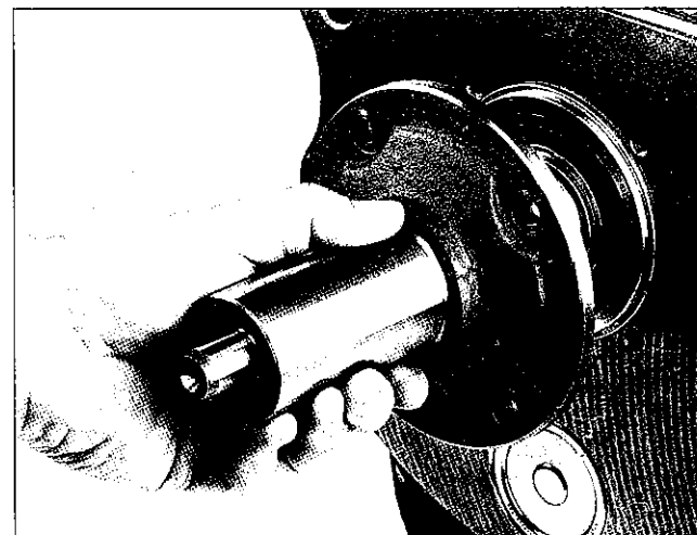
1.12 Passar adesivo Loctite 515 na face da tampa retentora do rolamento do eixo piloto. Montá-la observando sua posição correta. 1.12 Apply Loctite 515 on the contact surface of the input shaft bearing cap and install it in the correct position.
