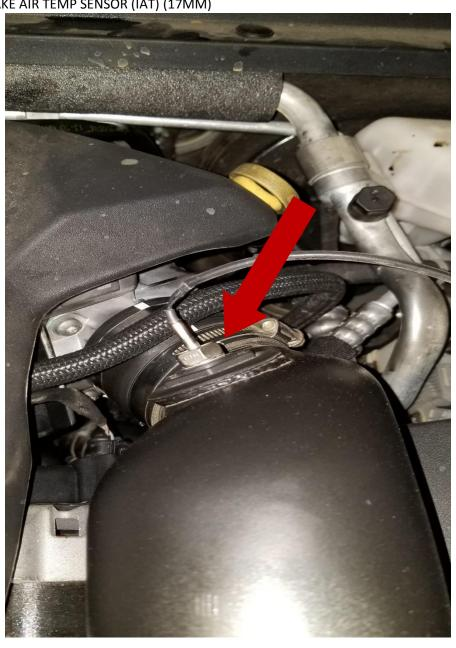
5. DISCONNECT INTERCOOLER PIPE FROM THROTTLE VALVE (ITEM #1) (FLAT BLADE SCREW DRIVER)
