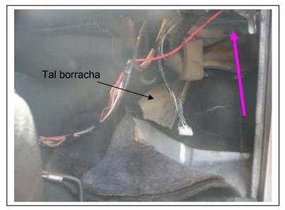
A foto acima mostra o carpete ensopado e puxado um pouco. A peça por onde a água está vazando fica bem onde a seta rosa aponta, atrás da tal borracha forrada com espuma.
