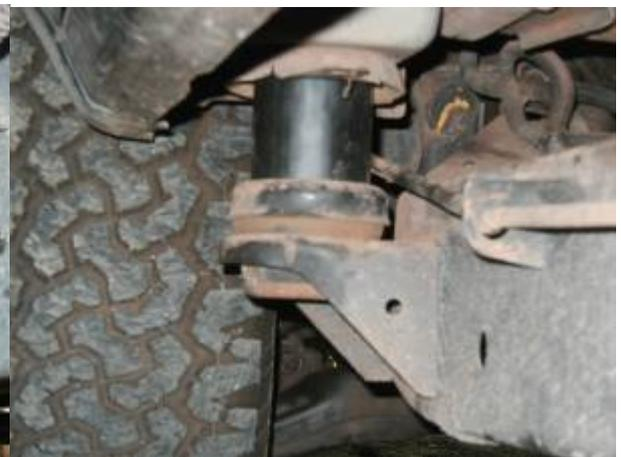
**Calço de 75mm x 50mm (item 06), instalado nos 10 pontos sobre a caçamba e 4 no suporte do pára-choque dianteiro**
