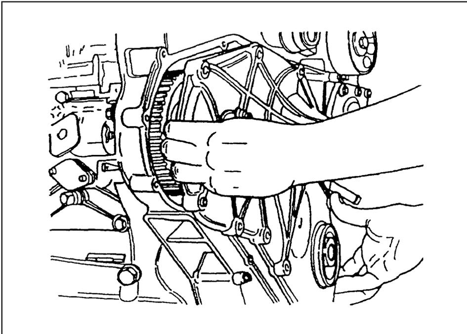
Retire a polia da árvore de manivelas e instale a tampa da caixa de distribuição.
