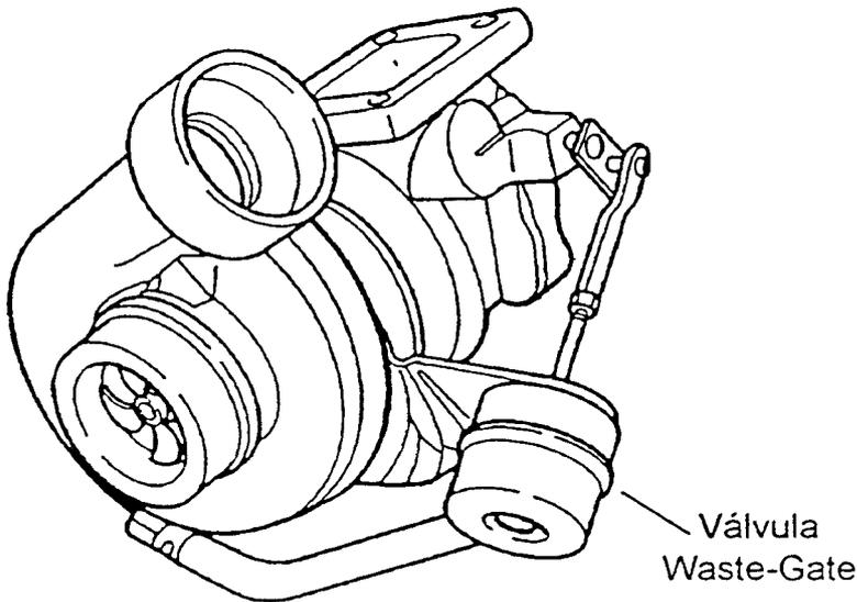
A válvula Waste-Gate faz parte do conjunto do turbo e não deve ser removida.
