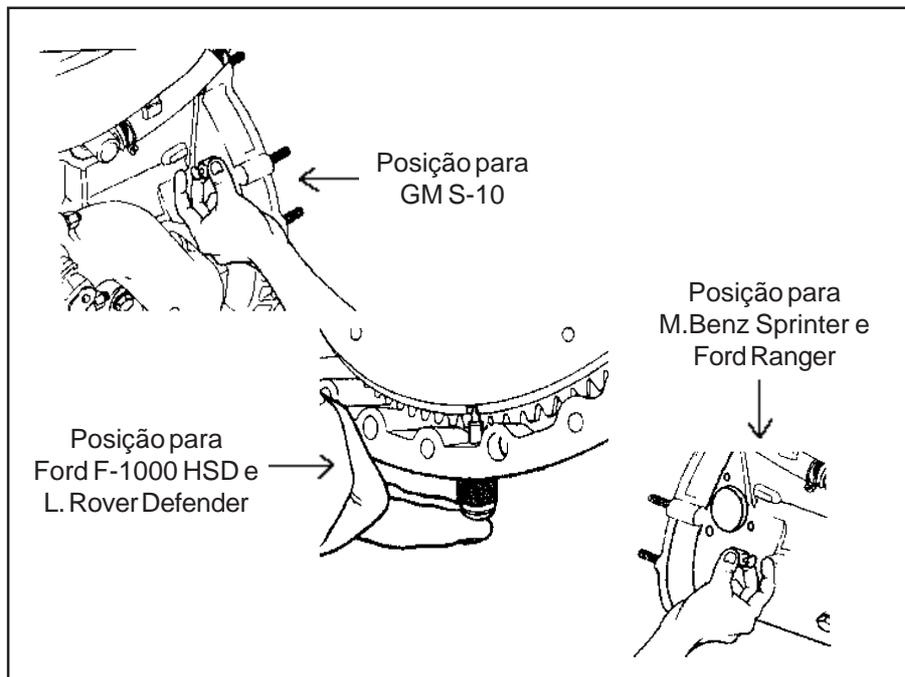
Agora solte o parafuso da parte traseira da placa adaptadora e instale a ferramenta especial nº 8130632 até que se encaixe no orifício do volante.
