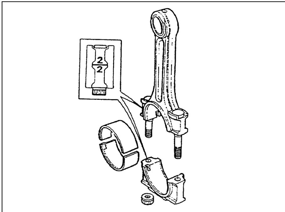
Com o casquilho instalado, lubrifique e encaixe a capa na respectiva biela, obedecendo a numeração gravada e o lado de montagem.
