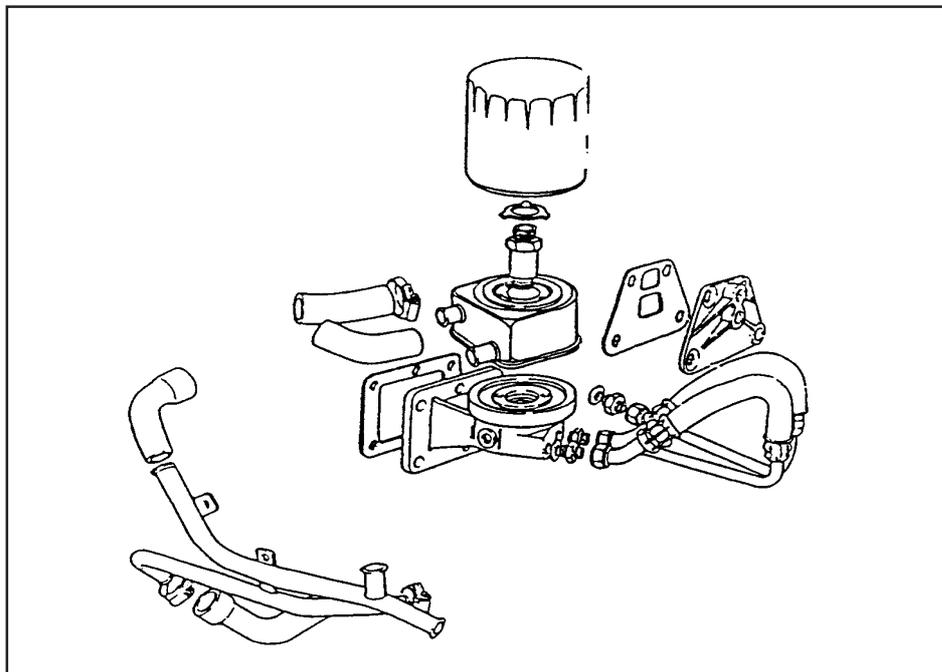
Na parte lateral do motor, remova as mangueiras do resfriador de óleo, o filtro de óleo, o parafuso de fixação e o resfriador.
