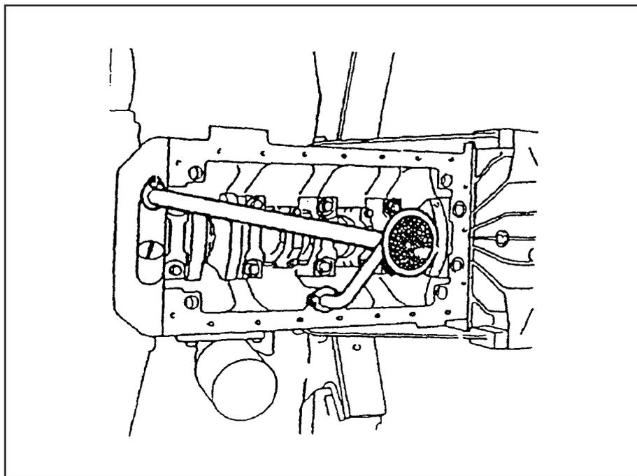
Gire o motor, solte os parafusos, retire o cárter, o tubo de sucção e o tubo do respiro.
