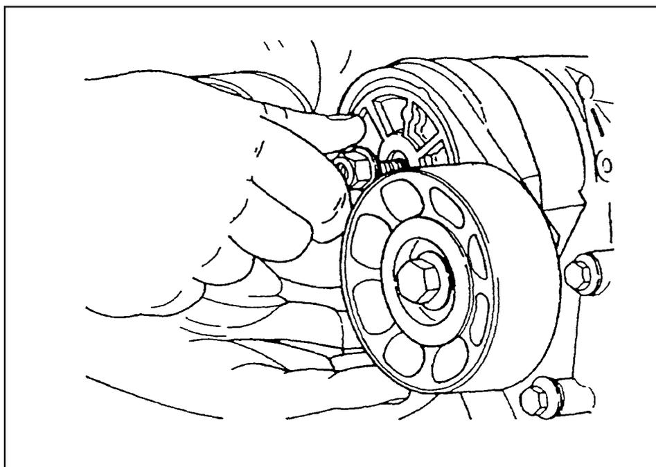
Remova o tensionador externo e, em seguida, o do ar condicionado.
