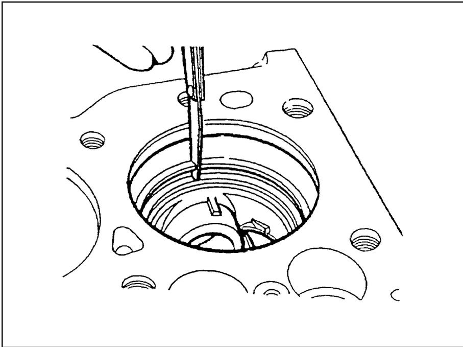
Verifique a folga entre pontas dos anéis no cilindro. A folga deverá ser verificada separadamente. O diâmetro interno do cilindro deverá estar dentro das medidas especificadas. Confira os valores especificados para a folga entre pontas dos anéis.
