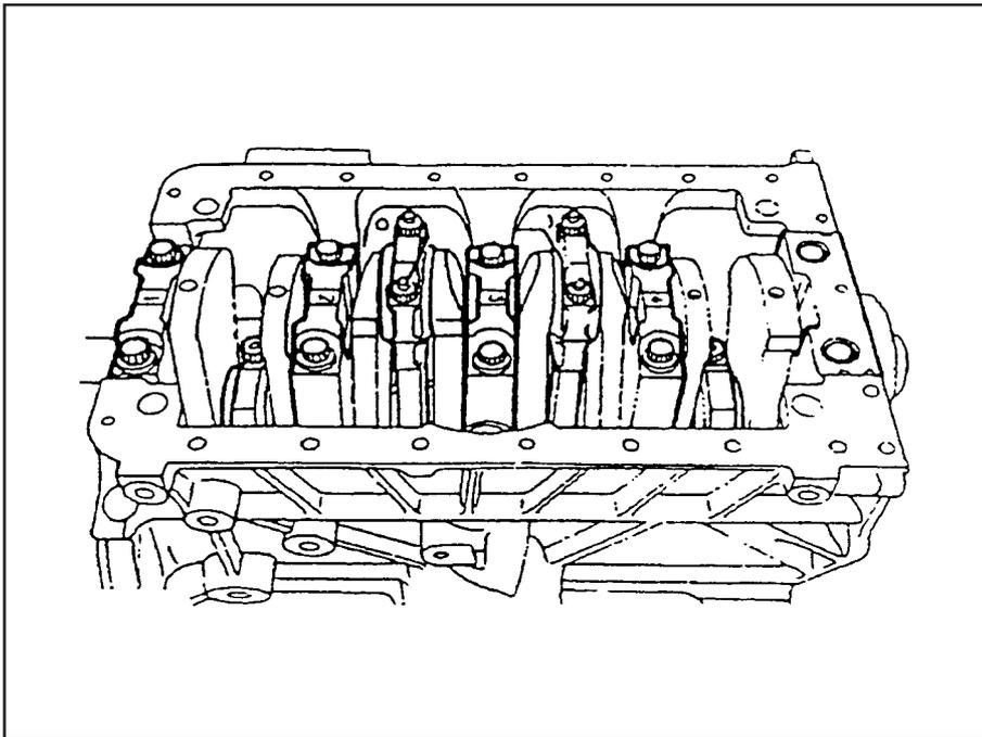
Observe os números correspondentes a cada mancal. Com o auxílio de um martelo de plástico, bata levemente nas capas dos mancais, para assentá-los. Aperte os parafusos dos mancais principais, com o torque de 133 Nm, sempre girando a árvore de manivelas.
