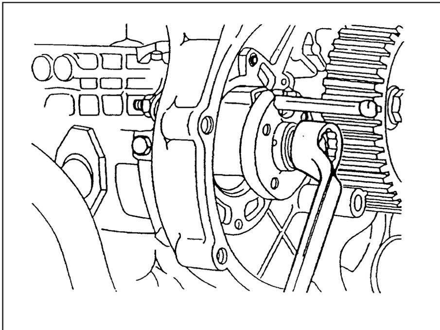
Instale o tensor interno da correia dentada e a polia do comando de válvulas. Instale a ferramenta especial nº 8130633 na bomba injetora, até que se encaixe no flange.
