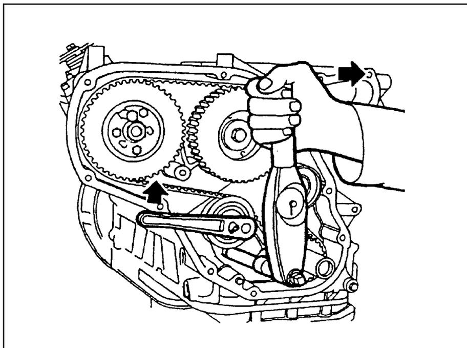
Com o motor travado, instale a correia dentada.
