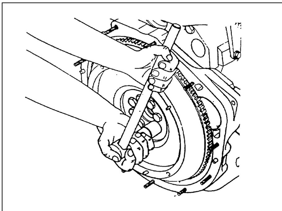
Instale a placa adaptadora do volante e o volante. Passe um travamento químico (Loctite) nos parafusos e aperte-os com o torque especificado de 146 Nm.
