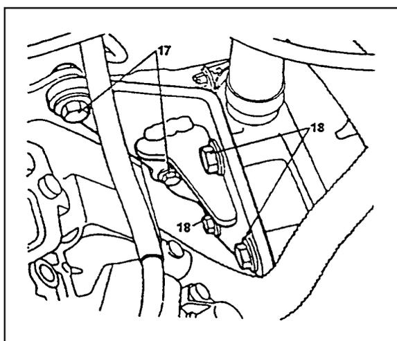
17. Remova os dois parafusos do suporte de montagem da bomba.
