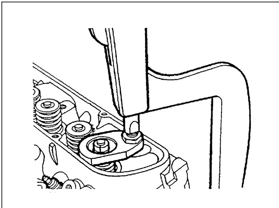
Para retirada das válvulas do cabeçote, instale a ferramenta nº 8130001 e remova as travas. Em seguida, solte a ferramenta e retire o prato, a mola, o retentor e a válvula.
