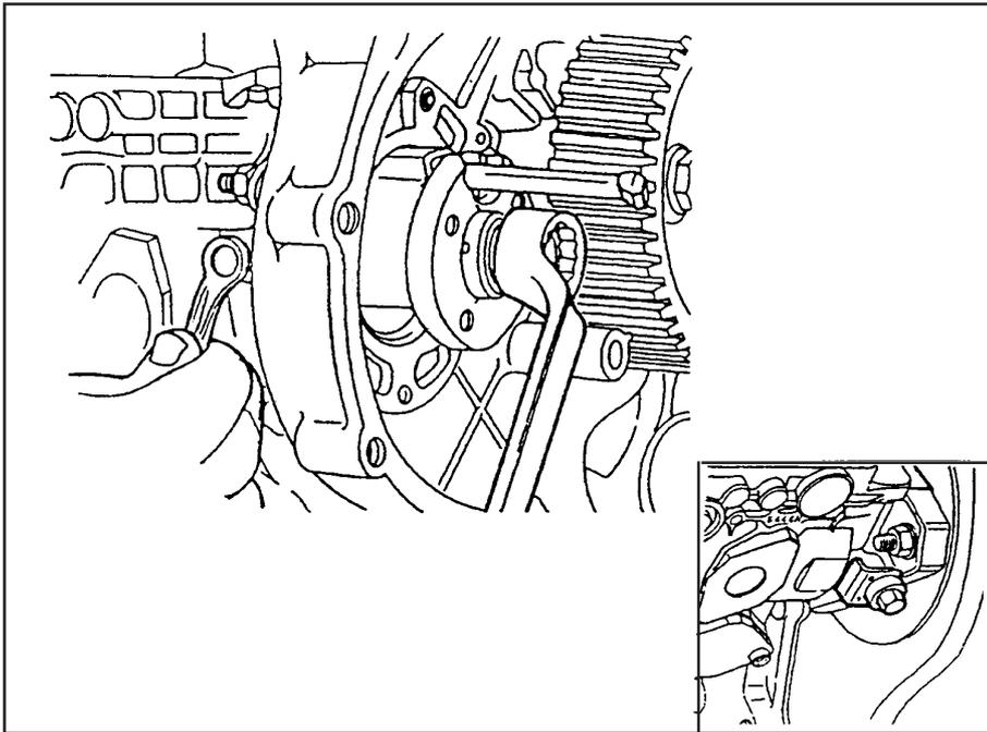
Em seguida, trave a bomba, retirando o limitador e apertando o parafuso, localizado em sua lateral. Certifique-se do livre deslizamento do pino de sincronismo. Não aperte ainda os parafusos das polias.
