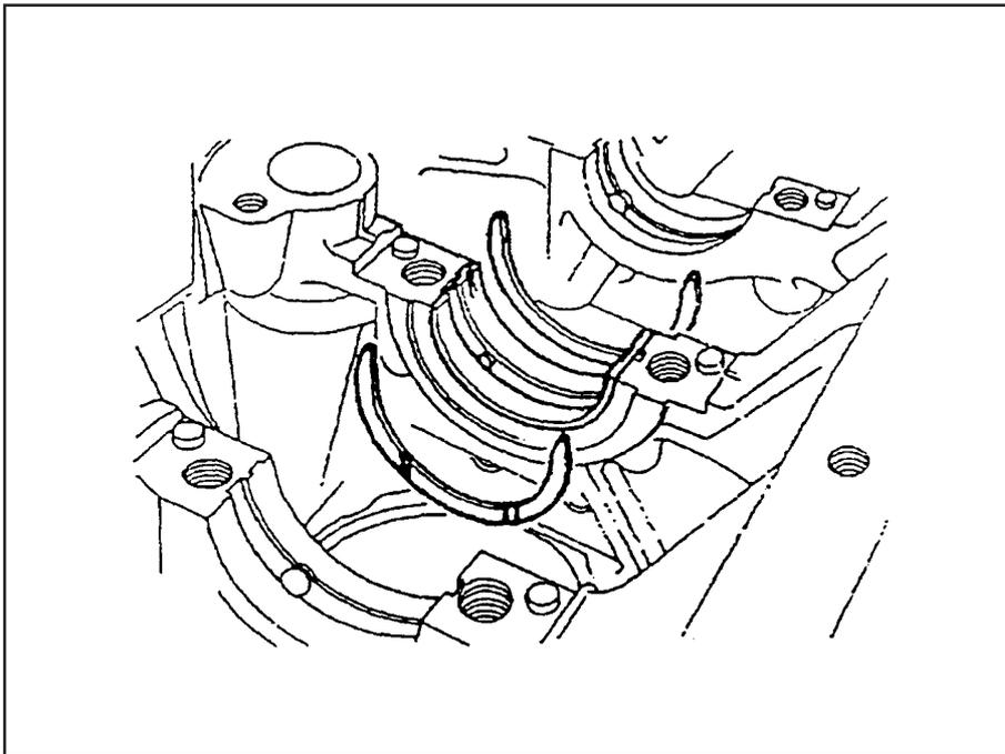
Coloque as arruelas de encosto no 3º mancal e instale a árvore de manivelas em seu alojamento. Instale as capas dos mancais principais com os casquilhos lubrificados. Não esqueça de utilizar a ferramenta especial nº 8130630, para a montagem do 5º mancal.
