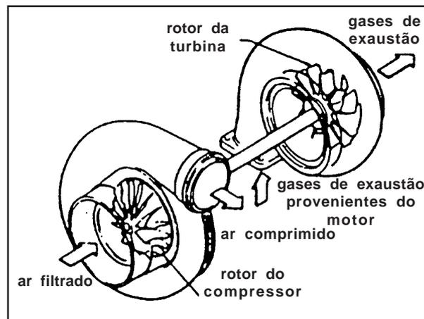
Com a rotação, o ar atmosférico (que deverá estar devidamente filtrado) é aspirado, e posteriormente, comprimido pelo rotor do compressor, de onde segue para os cilindros do motor.
