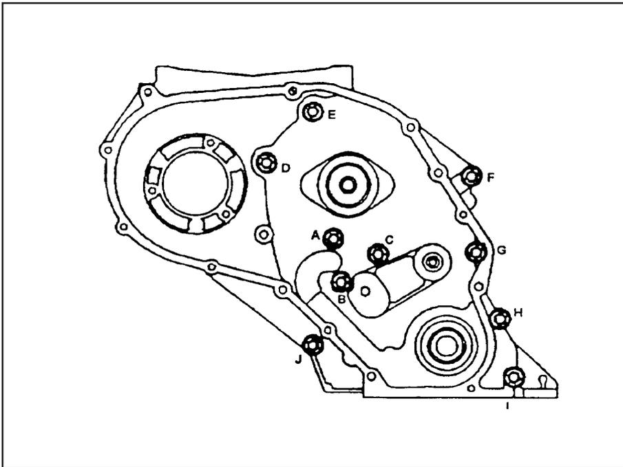
Instale o eixo comando de válvulas, fixando-o com a placa ao bloco.
