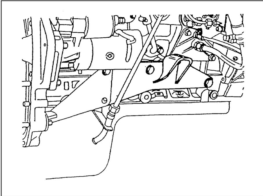
Remova o suporte de fixação da bomba injetora e a placa defletora de óleo. Feito isso, remova as duas partes do suporte de fixação do coxim e a placa de conexão das mangueiras de lubrificação.
