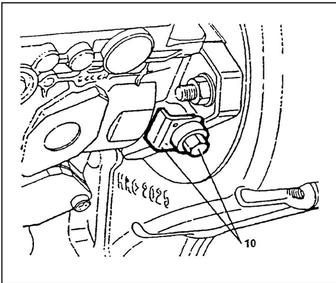
10. Remova a trava do parafuso, apertando-o, para travar a bomba.
