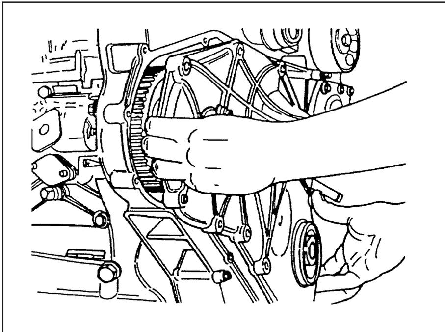
Remova a tampa da caixa de distribuição e a junta.
