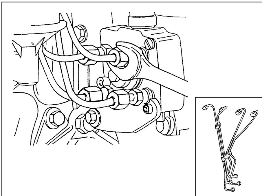
Retire o tubo do batente limitador de fumaça, na bomba injetora (LDA). Posteriormente, retire os tubos de alta pressão, protegendo-os, para não danificá-los.
