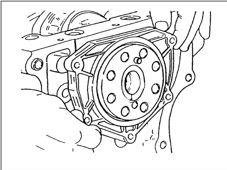
Solte os parafusos da carcaça do retentor traseiro e remova o conjunto.
