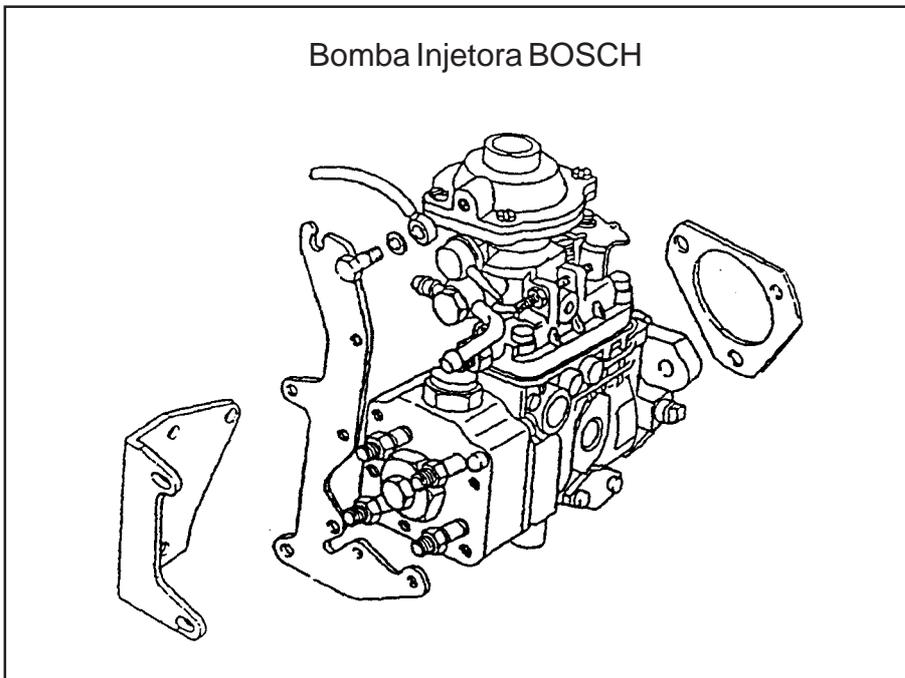
Solte os parafusos de fixação e remova a bomba injetora e a junta. Caso a bomba injetora apresente algum problema, a mesma deverá ser encaminhada a um Serviço Autorizado BOSCH.
