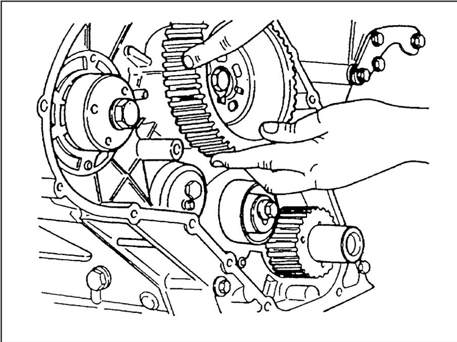
Afrouxe os parafusos de fixação das polias e o parafuso do comando de válvulas. Em seguida, remova as polias dentadas e a correia. Marque o sentido de rotação da correia, caso venha a reutilizá-la.
