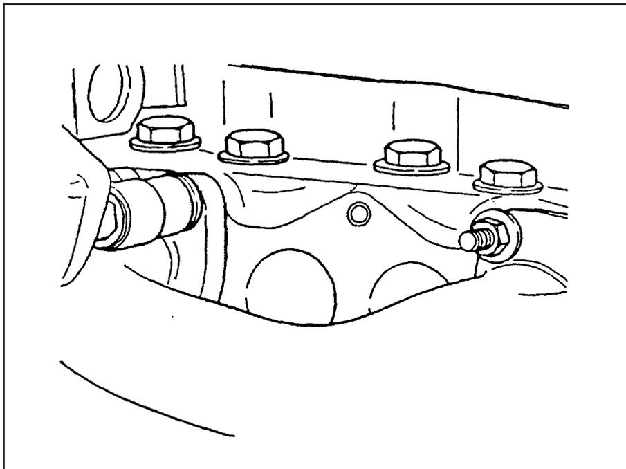
Solte as porcas de fixação do coletor de escape e remova-o com o turbo. Caso seja necessário uma análise mais detalhada do turbo compressor, encaminhe-o a um posto autorizado Garrett.
