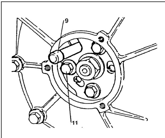
7. Continue girando a árvore de manivelas no sentido horário até que o pino de centro encaixe no orifício de sincronismo do volante do motor.
